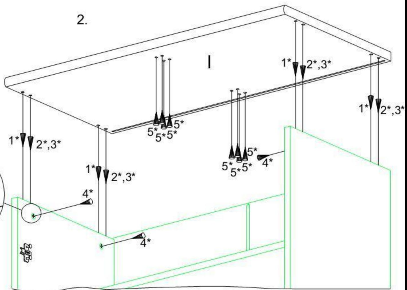
В отверстия, соответствующие отверстиям в верхних торцах боковин шкафов, забить шканты (1) и цанговые футерки (5) (рис.1). В футерки вкрутить дюбеля стяжек-эксцентриков (6) до упора в обод (рис.1).
