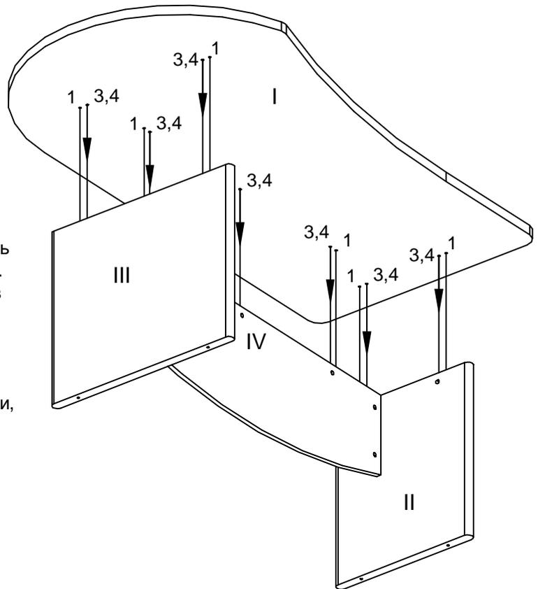
Положить столешницу (I) отверстиями вверх. Забить в столешницу (I) шканты (1) и цанговые футорки (4). Вкрутить в цанговые футорки дюбеля (3) до упора в обод. Надеть столешницу (I) на каркас и затянуть отверткой стяжки-эксцентрики (2) на стенках боковых (II, III) и планке продольной (IV). Закрыть торцы стяжек-эксцентриков декоративными заглушками (7). Отрегулировать, при необходимости, высоту стола, подвинтив опоры (5).
