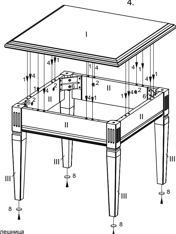
Установить столешницу (I) на каркас стола и закрепить, поворачивая стяжки-эксцентрики (2) в царгах (II) отверткой по часовой стрелке (рис. 4).
