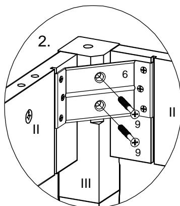
Закрепить ногу (III) к уголку (6), ввернув винты (9) через отверстия в уголке (6) в футорки (3) и прилагая усилия затянуть винт (9) к уголку (6) до полного закрепления (рис. 2). Закрепить все ноги (III) аналогичным образом.
